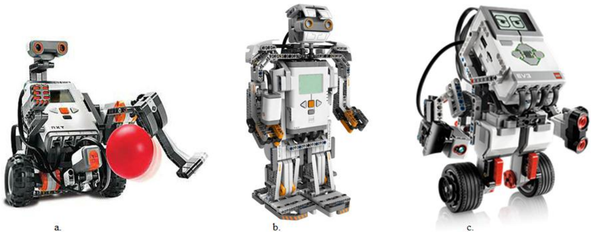
Figura 1 – Evolução do kit LEGO MINDSTORMS a. LEGO MINDSTORMS EDUCATION NXT BASE SET ; b. LEGO MINDSTORMS NXT 2.0 ; c. LEGO EDUCATION EV3 .
