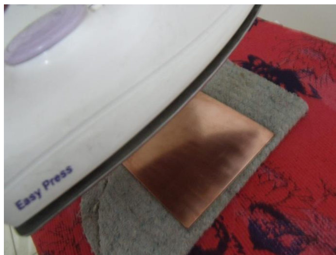
Figura 15 – Aquecimento da superfície cobreada da placa de fenolite
